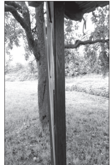
Iskolai tananyag fizikából, hogy a fa rossz elektromos vezető, továbbá az is, hogy az elektromosság mindig a legrövidebb utat keresi az ellentétes pólus felé. A képen a kiülő fából készült, villám által sújtott tartógerendái. D.
