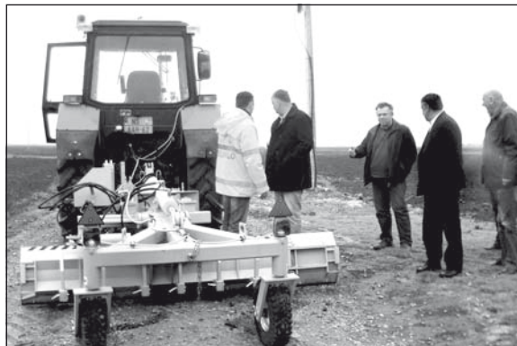
A dűlőutak egyengetésére szolgáló traktor vontatta földgyalu
